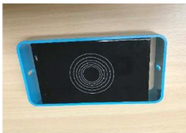
圖 5 NFC 無線溫度感測器（硬殼包裝版）
