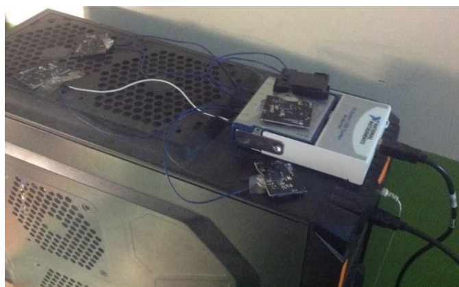
圖 12 以 DAQ 連結 SensorTag 擷取耗電量
